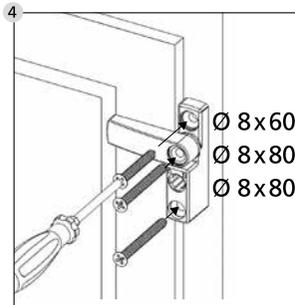
Monte a proteção de janela com os calços e os parafusos fornecidos. **Evite um aperto excessivo dos parafusos.**
