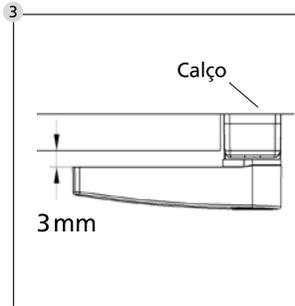
Calce a proteção de janela por meio de inserção de calços para obter uma distância de cerca de 3 mm entre a alavanca do pivô e o batente da janela.
