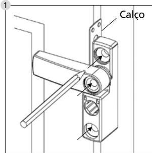
Abra a proteção de janela com a chave inserida e remova a chave. Gire a alavanca de pivô para o lado e posicione a proteção de janela no caixilho da janela na posição desejada. Por meio de um **calço de 1 mm** defina uma distância até ao batente da janela e marque as 3 posições dos furos com um lápis.
