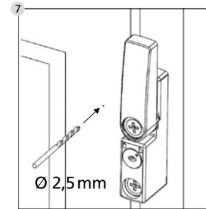
Aprofunde a marcação, de modo simples, por exemplo por meio da ponta de um parafuso/martelo e perfure com uma broca de 2,5 Ø.
