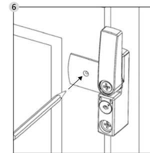
Gire a alavanca do pivô lateralmente e marque com um lápis a posição dos furos da placa do batente.
