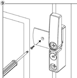
9 Pressione a placa do batente no batente da janela e monte o parafuso 2,9x13 Ø. **Evite o excesso de aperto dos parafusos.**
