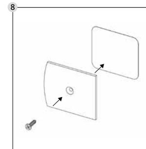
Cole um adesivo de dupla-face na parte de trás da placa do batente. Na parte da frente, o parafuso de cabeça chata deve ficar visível. Perfure a placa adesiva com o parafuso de cabeça chata de Ø 2,9x13.
