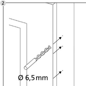
Aprofunde as marcas, de modo simples, por exemplo por meio da ponta de um parafuso/martelo e perfure os 3 furos com uma broca de 6,5 Ø. **Não perfure os caixilhos das janelas.**
