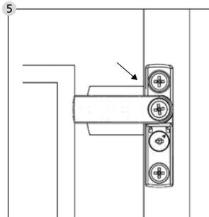
Posicione a placa do batente centrada abaixo da alavanca do pivô e nivelada com o lado do batente da janela, e mantenha na posição.
