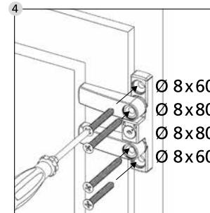
Namontujte okenní pojistku pomocí vybraných podložek a přiložených šroubů.
