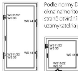
Hloubka vrtaných otvorů a délka šroubů musí být upravena podle místních specifik. Okna/balkónové dveře neprovrtávejte, pracujte případně s hloubkovou zárážkou. Při vrtání pozor na poškození pohyblivých dílů, těsnění nebo okenních tabulí. Doporučujeme utahovat upevňovací šrouby rukou, zabránite tak jejich překroucení.
