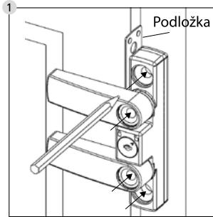
Pomocí přiloženého klíče okenní pojistku otevřete a klíč vytáhněte. Obě sklopné páky otočte na stranu a okenní pojistku přidržte na okenním rámu v požadované poloze. Pomocí **podložky o tloušťce 1mm** vytvořte odstup od okenního křídla a tužkou si označte 4 místa pro vrtání.
