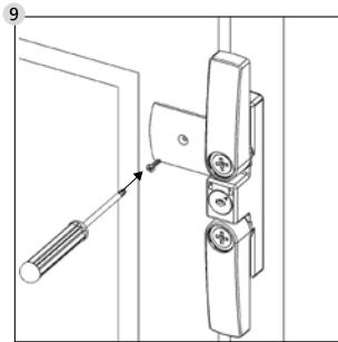
9 Oplechování křídla přitiskněte rovně na okenní křídlo a namontujte šroub o Ø 2,9x13. **Pozor na překroucení šroubu.**
