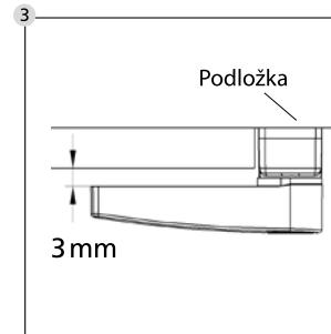
Podložte okenní pojistku přiloženými podložkami tak, aby mezi sklopnou pákou a okenním křídlem vznikla mezera cca 3 mm.
