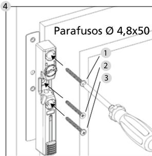
Monte a proteção de janela com os calços. **Evite um aperto excessivo dos parafusos.**
