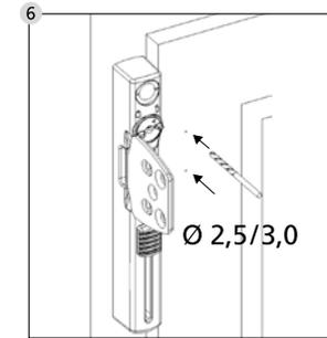
Aprofunde a marcação, de modo simples, por exemplo por meio da ponta de um parafuso/martelo e perfure com uma broca de Ø2,5, para madeira e Ø 3,0 para alumínio ou plástico com inserções em metal.
