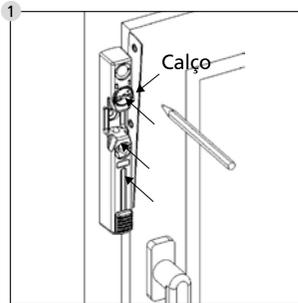
Abra a proteção de janela com a chave inserida e remova a chave nesta posição. Posicione a proteção de janela na posição desejada. Por meio de um calço de 2 mm defina uma distância até ao batente da janela e marque as 3 posições dos furos com um lápis.
