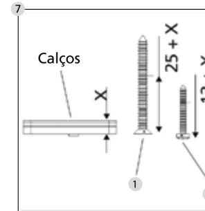
Se utilizar calços para a placa do batente, encurte em conformidade os 2 parafusos de cabeça redonda 3,5 x 25 e 1 parafuso de cabeça chata 4,8x50.
