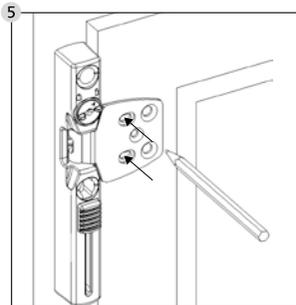
Insira a placa do batente na proteção de janela, e desloque a guia para cima. Se necessário, calce a placa do batente por meio de calços. Alinhe a placa do batente e marque nas 2 fendas oblongas 2 posições de perfuração com um lápis.
