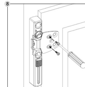
Monte os 2 parafusos de cabeça redonda Ø 3,5 x 13 ou os parafusos encurtados. **Evite um aperto excessivo dos parafusos.**
