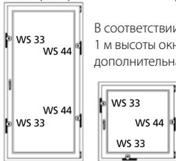
В соответствии с DIN 18104-1 должна быть на каждом 1 м высоты окна установлена, как минимум, одна дополнительная защелка. На стороне открытия (оконные ручки) должна быть, по крайней мере, одна дополнительная запирающийся защелка
