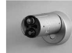
3. Τοποθετήστε πίσω το κάλυμμα από σιλικόνη, κλείστε το καπάκι και σφίξτε τη βίδα στερέωσης.
