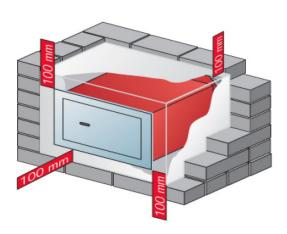
**Aviso importante:** concidere que una instalación en paredes que den hacia el exterior puede provocar condensación de agua debido a las diferencias de temperatura.
