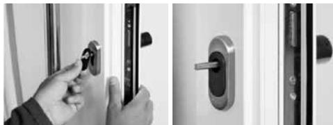
7 Spingere la manopola esterna sull'albero nella posizione desiderata e fissarla ad una distanza di almeno 1 mm dalla cerniera mediante la vite senza testa.
