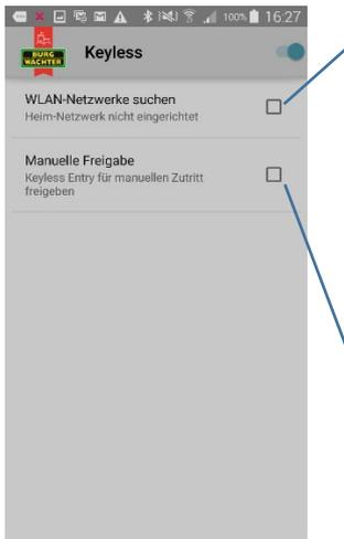
Auswahl des WLAN- Netzwerkes über das die Kommunikation stattfinden soll. Nach der einmaligen Öffnung ist das System für 3 Minuten keyless aktiv, d.h. innerhalb von 3 Minuten öffnet das Schloss automatisch sobald Sie sich im Empfangsbereich befinden und vom System detektiert worden sind. Danach schaltet sich die Keyless-Funktion wieder ab.
