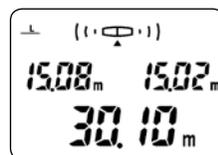
1. Préréglage sur la mesure bidirectionnelle
