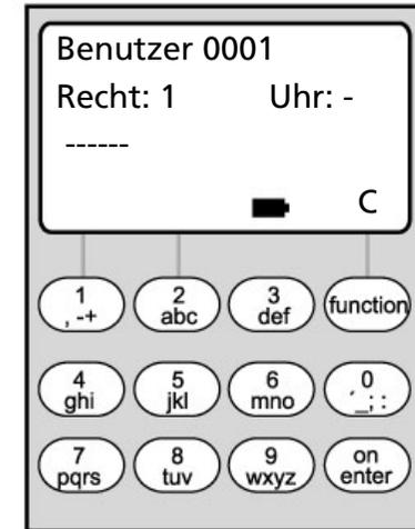
Beispiel: C. Koenig hat alleiniges Zugangsrecht (1), ist der Wochenzeitschaltuhr B zugeordnet und verfügt über den Zugangscod 987654
