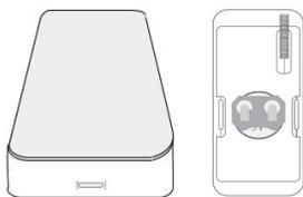
1. Ouvrez le boîtier avec un tournevis plat. Pour cela, insérez avec précaution le tournevis dans la fente sur le côté du détecteur où se trouve la LED d'état.
