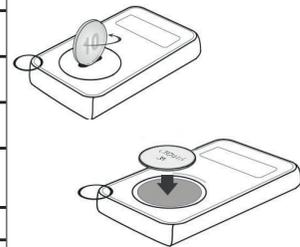
1. Ouvrez le compartiment à l'aide d'une pièce en tournant le couvercle dans le sens contraire des aiguilles d'une montre.
