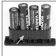
Deslice la tapa junto con las baterías de nuevo en la electrónica de la cerradura y apriete los tornillos.
