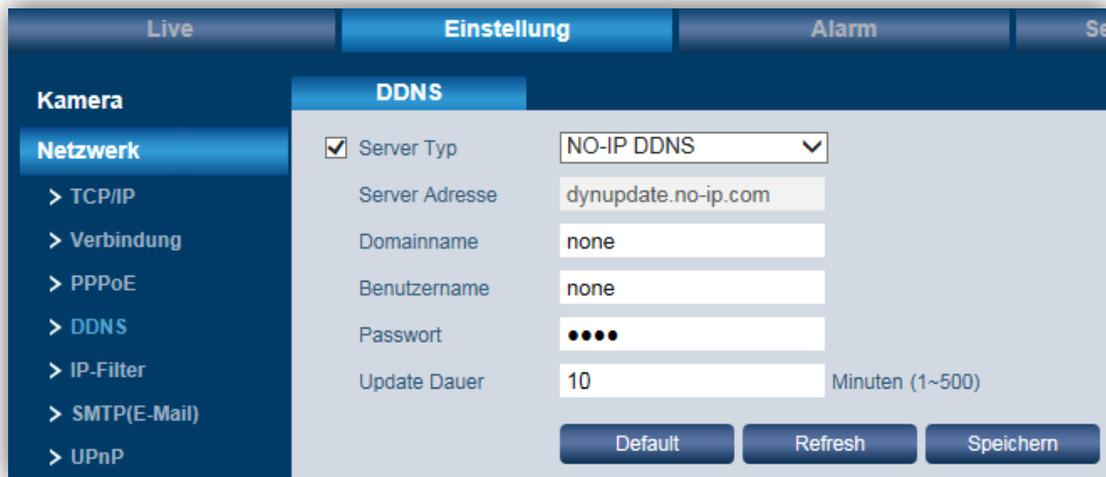
DDNS kann genutzt werden, um auf das System von außerhalb Ihres Netzwerks zuzugreifen. Hierzu ist die Anbindung an einen externen Server nötig.
