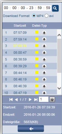
Durch einen Doppelklick auf einen Eintrag (Startzeit) werden unten in der Liste die Start- und Endzeit der Aufnahme sowie die Dateigröße angegeben. Außerdem wird durch die Farbcodierung die Art der Aufnahme kenntlich gemacht (im Beispiel links: gelb = Bewegung).
